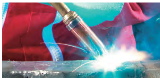
1) Газовое сопло - 2) Контактный наконечник - 3) Проволока 4) Защитный газ - 5) Дуга - 6) Сварочная проволока - 7) Шов 8) Основной металл
